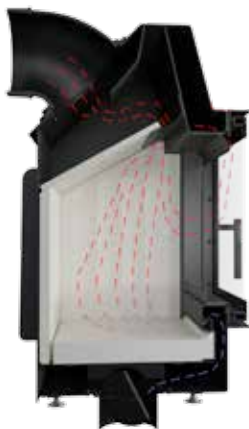
Rysunek 20. Schemat obiegu powietrza wewnątrz wkładów ZIBI The air circulation overview inside the inserts from the ZIBI Series.
