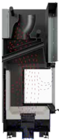
Rysunek 26. Schemat obiegu powietrza wewnątrz wkładów z serii NBC The air circulation overview inside the inserts from the NBC Series.
